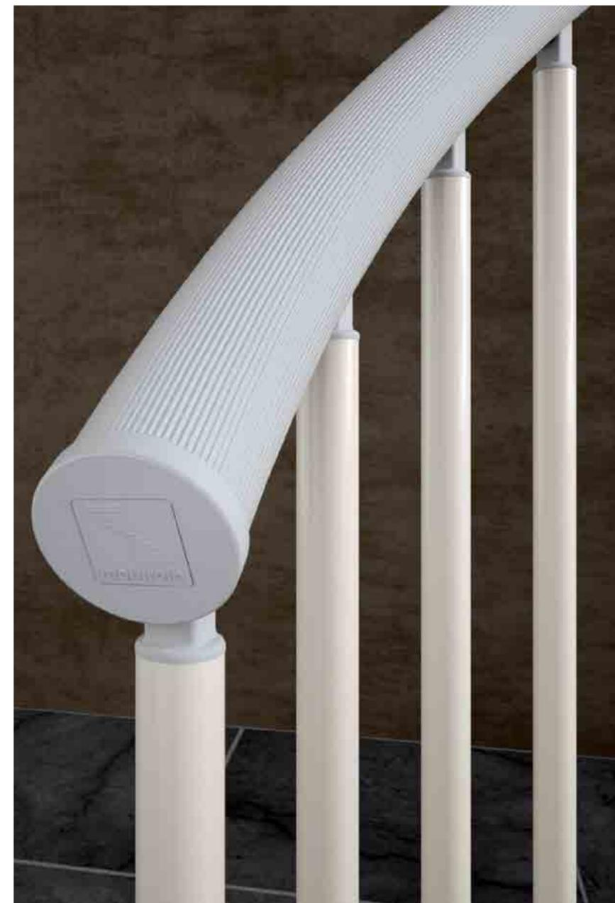
Star è una scala a chiocciola con un'anima in acciaio. I gradini sono ottenuti tramite stampaggio. Il piano di calpestio è protetto da una pedana in PVC, con uno spessore importante, per garantire una tenuta straordinaria nel tempo. La ringhiera è disponibile in due versioni. Il corrimano è realizzato da un profilo estruso in PVC.
