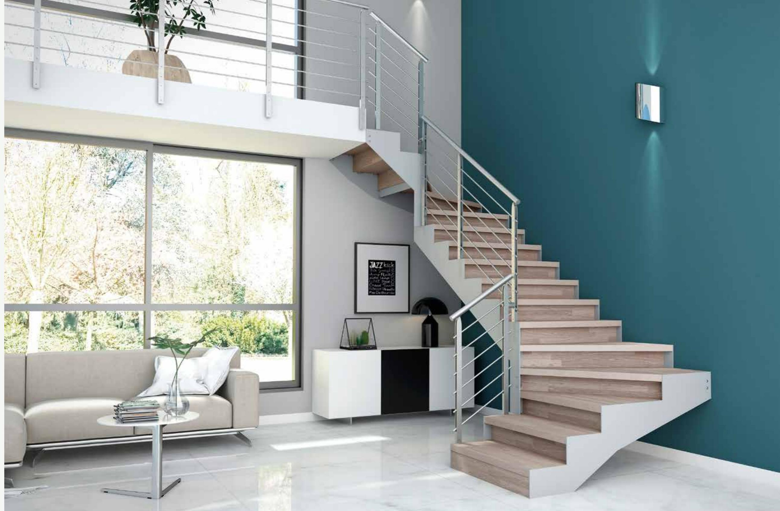
IT] Struttura verniciata, gradini in faggio lamellare spazzolato, ringhiera a colonne e tondini Inox.
