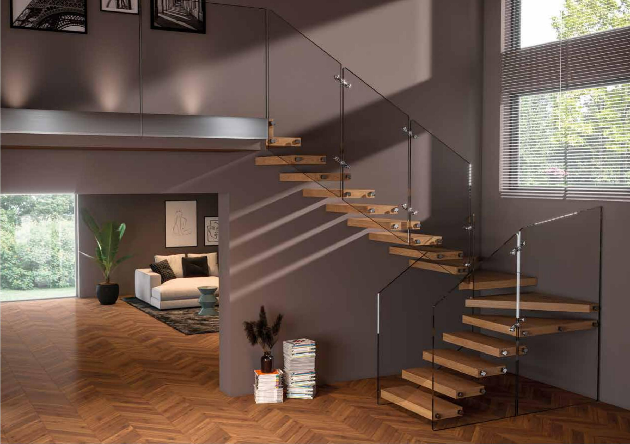
**IT**] Scala con gradini in rovere lamellare. Ringhiera a pannelli di vetro dritto stratificato e temprato 10+10 mm.
