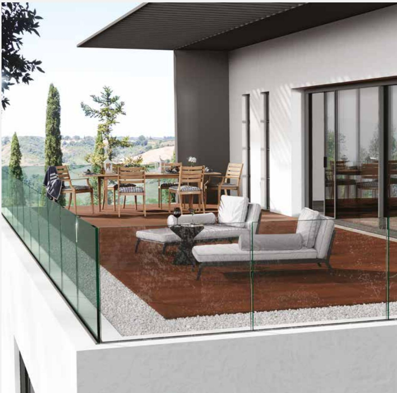
**IT**] Balaustra con lastre in vetro stratificato e base in alluminio, nella versione incassata al pavimento. Corrimano/profilo in acciaio Inox di finitura (optional).
