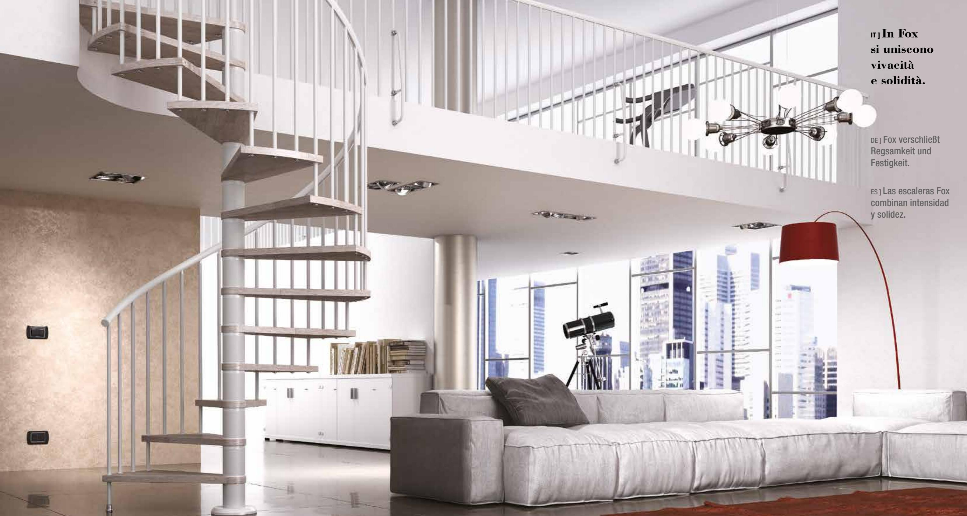
IT] Scala in legno, corrimano PVC grigio, colonne in metallo. La parte centrale di sostegno è in acciaio verniciato, i gradini sono in legno massello di faggio. La ringhiera in acciaio verniciato è composta da 3 colonne verticali per gradino. Il corrimano è disponibile in profilo estruso in PVC e in legno.
