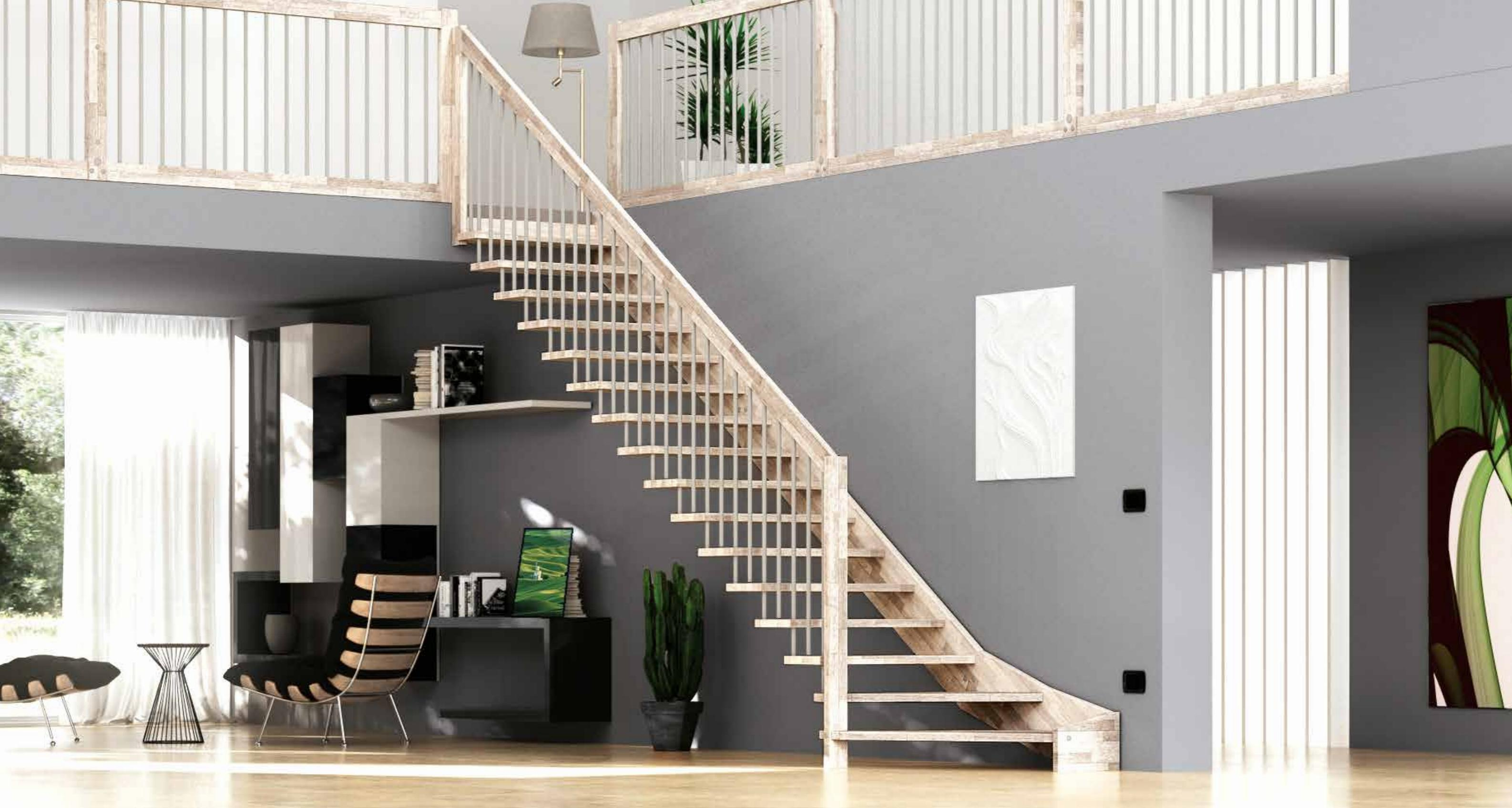
**IT**] Indian è una scala in legno a sbalzo, con colonne in acciaio verniciato. I gradini di spessore 40 mm, incastati nella struttura laterale assicurano grande stabilità e solidità al prodotto. La scala è progettata su misura. La portata è di 400 kg/m<sup>2</sup>.
