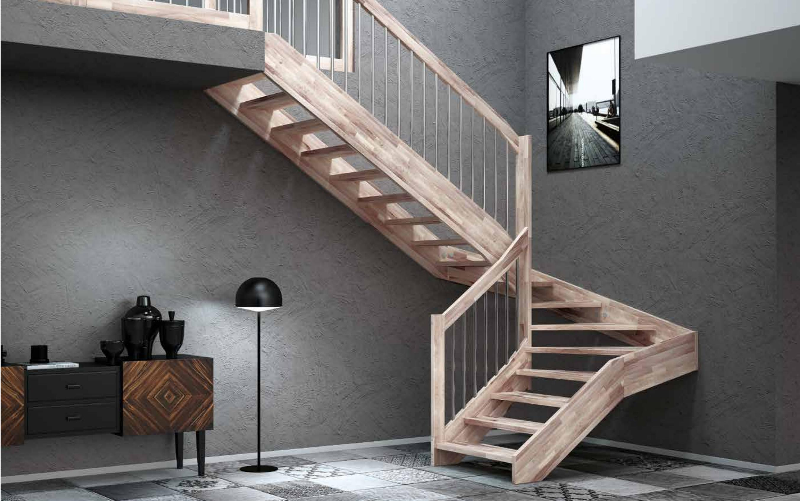
IT ] Athena CL è una scala in legno con colonne in acciaio verniciato o in acciaio inox. I gradini di spessore 40 mm sono incassati nella struttura e assicurano grande stabilità e solidità. La scala è progettata su misura. La portata è di 400 kg/m<sup>2</sup>.
